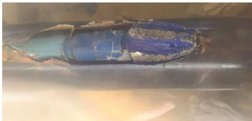
Рис. 4. Процесс стендовых испытаний "Перфобура" по фрезерованию обсадной трубы
