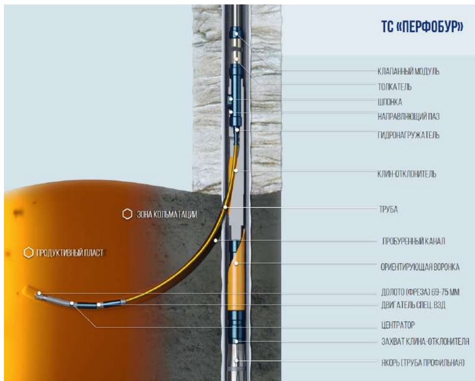
Рисунок 2. Основные элементы технической системы Перфобур
