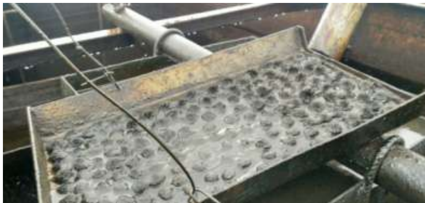
Рисунок 4. Вынос стружки в процессе фрезерования «окна»
