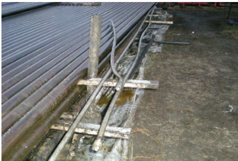
Рисунок 5. Изогнутые гибкие трубы при R_{пр} > R_{кр}
