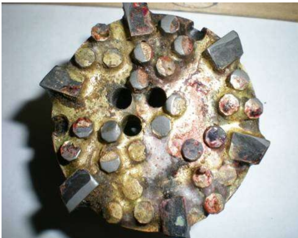
Рис. 28. Незначительный износ долота
