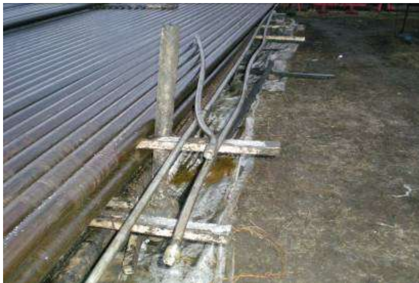
Рис. 41. Гибкие трубы после испытаний
