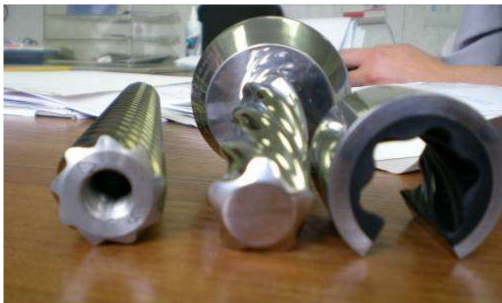
Рис. 6. ВЗД конструкции ВНИИБТ, ротор и статор двигателя Д43 (справа), ротор винтового двигателя Д42 (слева)
