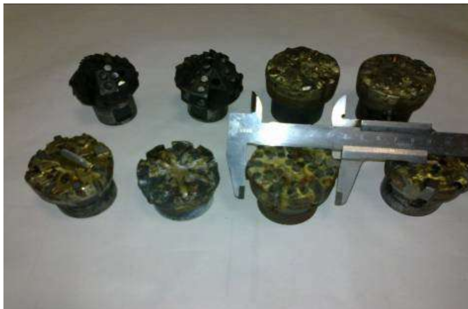
Рис. 16. Различные типы долот истерающе-режущего и режуще-скалывающего действия для перфобура
