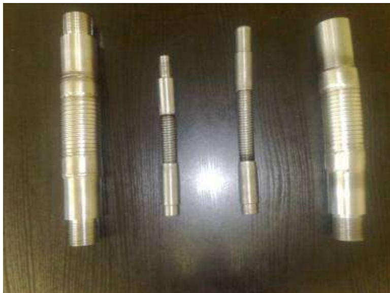
Рис. 30. Гибкие межкорпусные и межроторные сочленения конструкции перфобура
