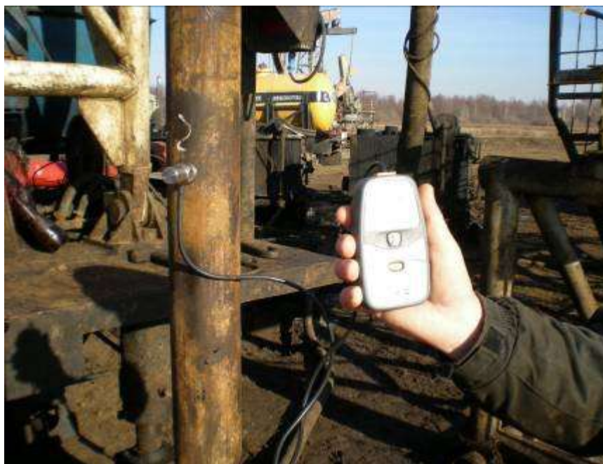
Рис. 39. Виброметр ВК 5М контролирует поперечные колебания КНБК при запуске ВЗД
