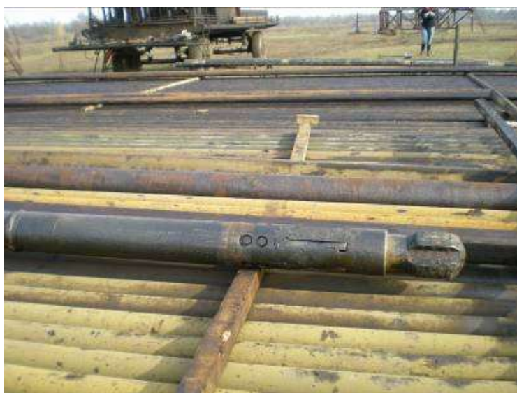
Рис. 34. Универсальное вырезающее устройство УВУ-146 после испытаний
