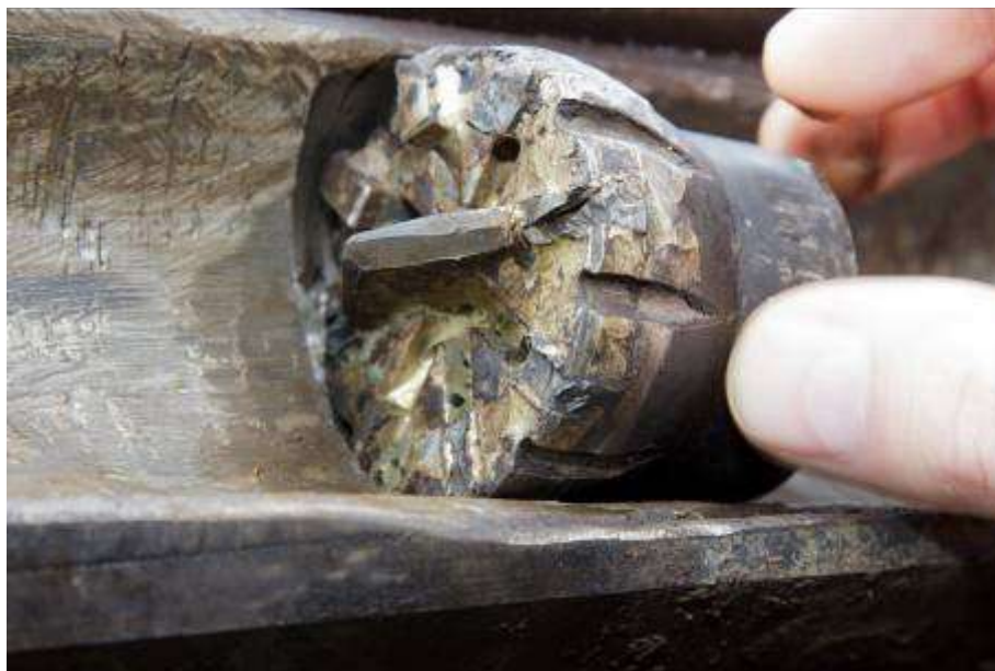
Рис. 45. Износ вкладыша отклонителя и долота
