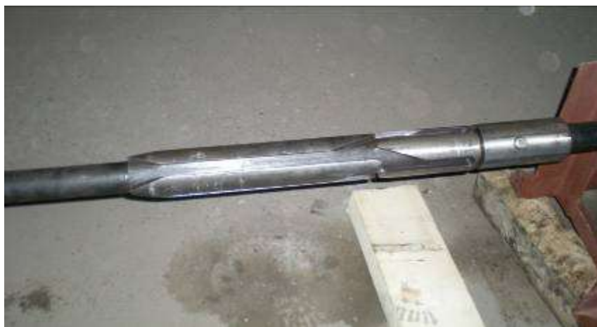
Рис. 23. Механизм поворота перфобура
