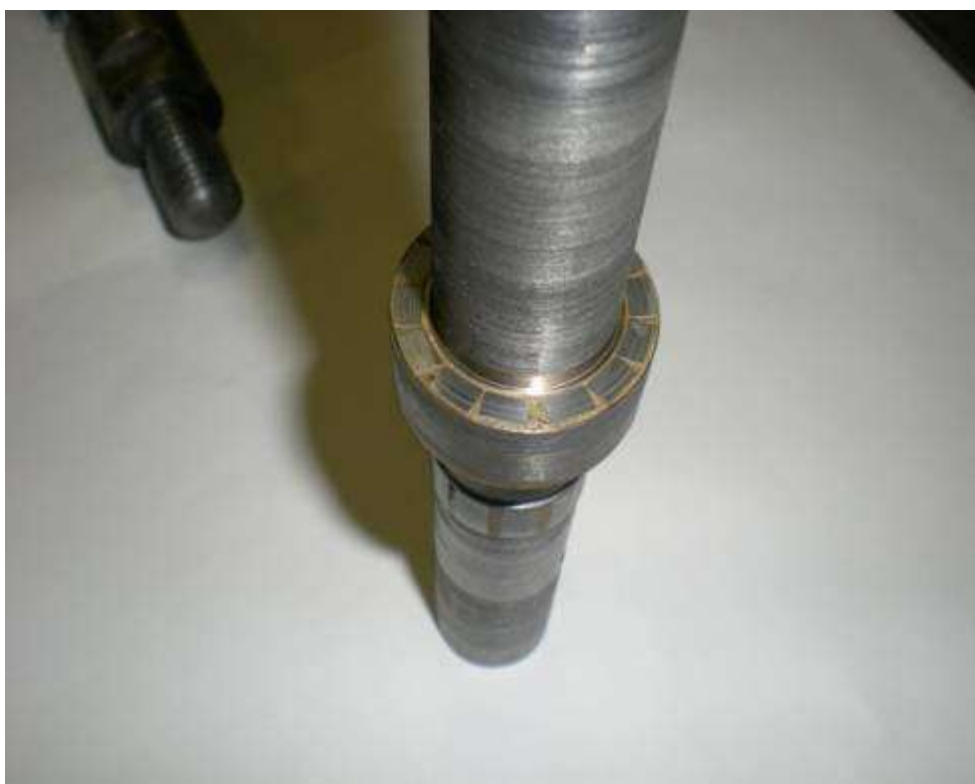
Рис. 29. Осевая опора шпиндельной секции
