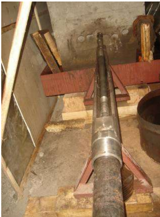
Рис. 4. Испытания на стенде (начало бурения шестого канала)
