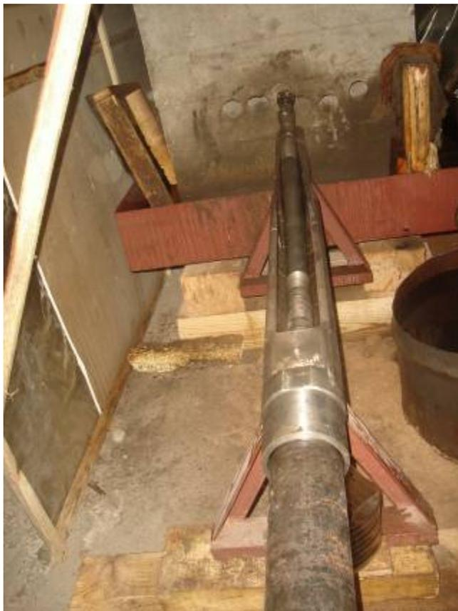
Рис. 4. Испытания на стенде (начало бурения шестого канала)
