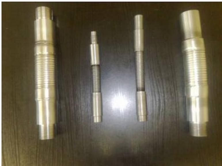
Рис. 30. Гибкие межкорпусные и межроторные сочленения конструкции перфобура
