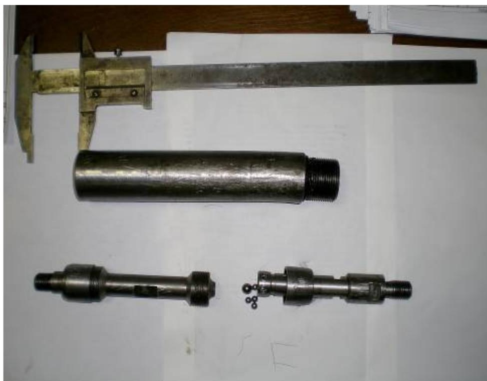
Рис. 27. Шарнирная секция
