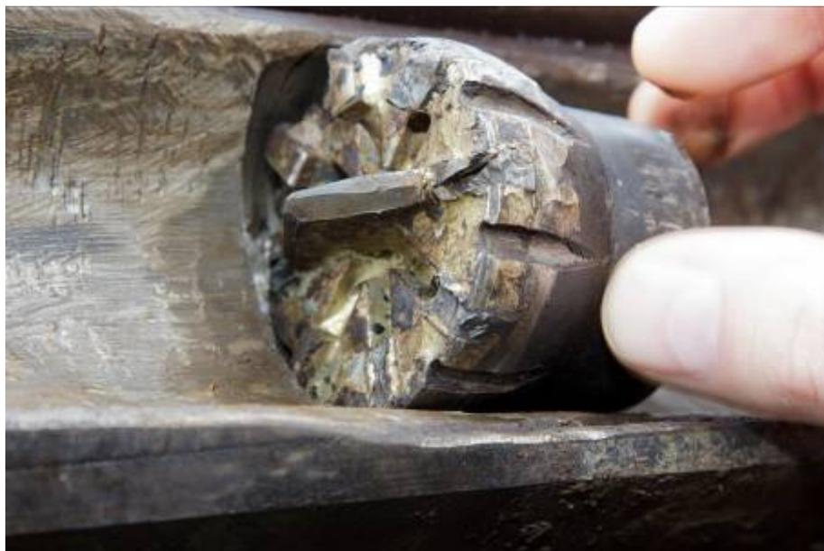
Рис. 45. Износ вкладыша отклонителя и долота
