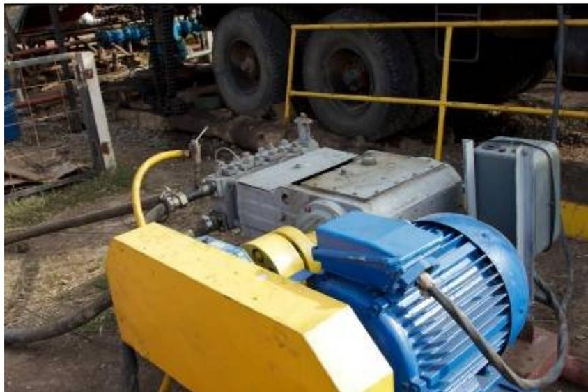
Рис. 44. Насосная станция с трехплунжерным насосом 1.3 ПТ-50Д2
