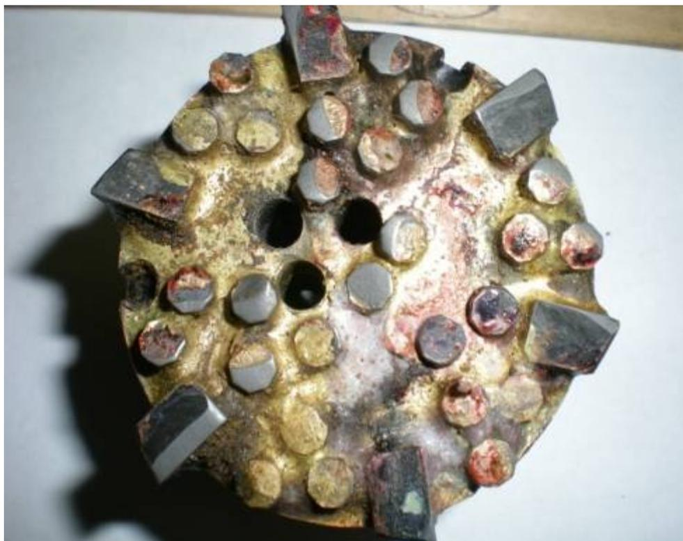
Рис. 28. Незначительный износ долота
