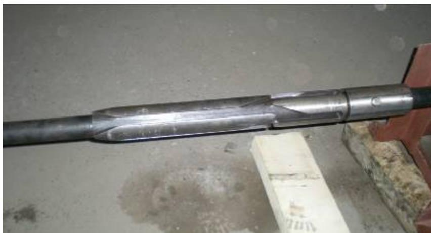
Рис. 23. Механизм поворота перфобура
