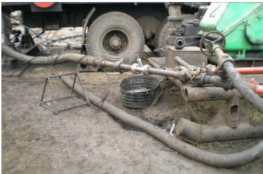
Рис. 38. Расходомер РСТ-16М в обвязке нагнетательной линии
