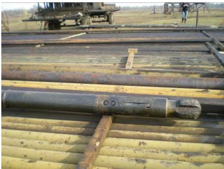
Рис. 34. Универсальное вырезающее устройство УВУ-146 после испытаний
