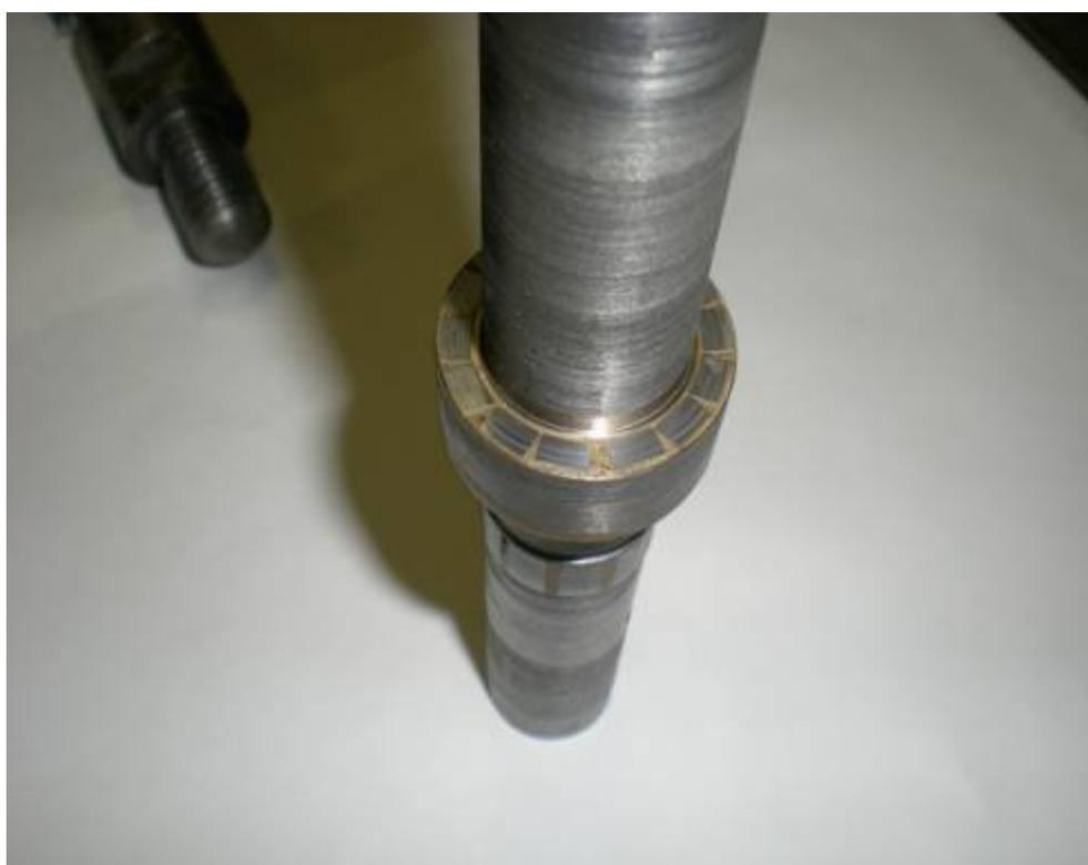
Рис. 29. Осевая опора шпиндельной секции
