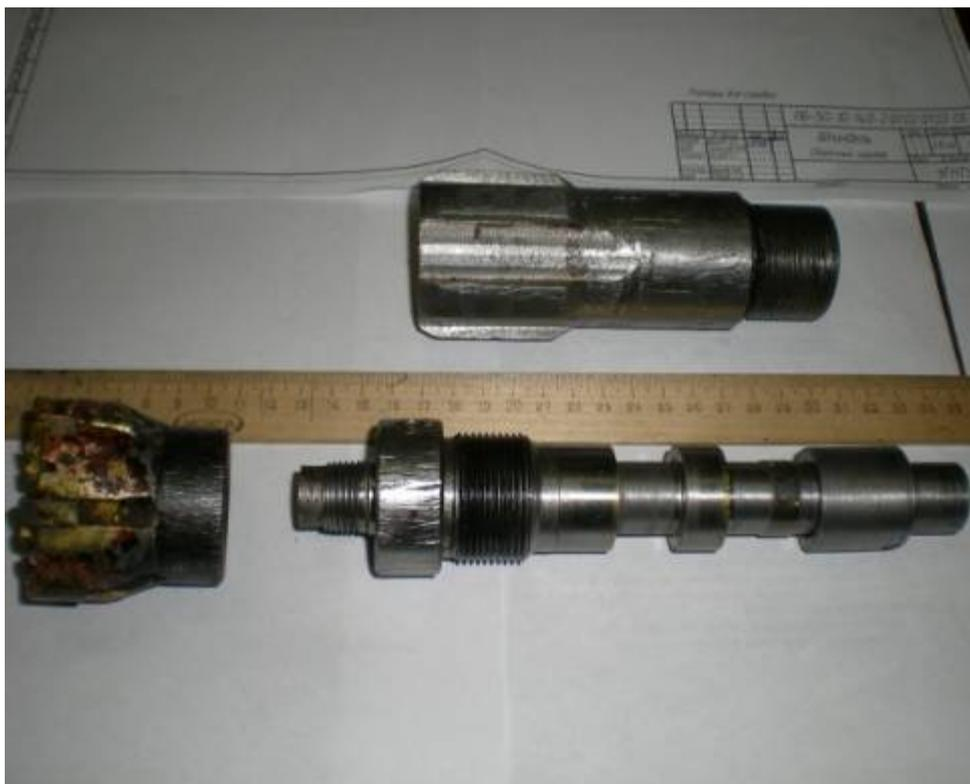
Рис. 26. Шпиндельная секция
